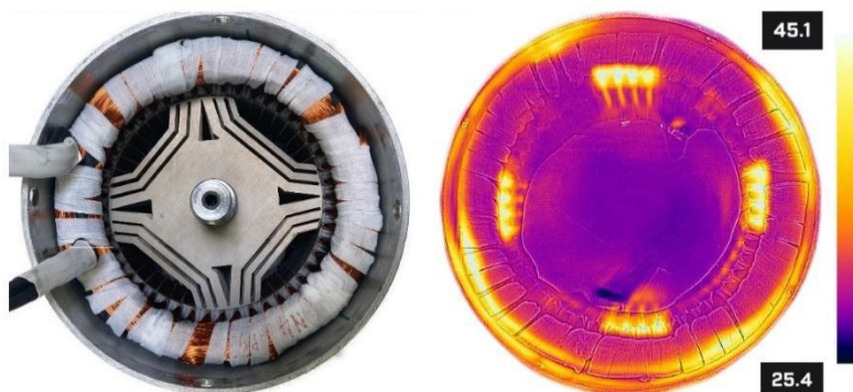
3. ábra Hőkamerás kép az egyenárammal melegített fázisról °C-ban 20
