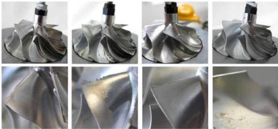
1. ábra: A lapátok eróziós kopása
